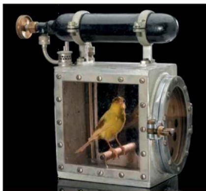
Il dispositivo che veniva utilizzato per rianimare i canarini nelle miniere di carbone.
